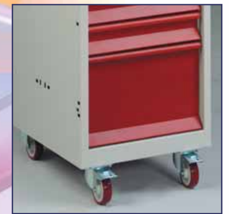
Adaptation roulettes sous coffres-socles. Roulettes Ø 100 : 2 fixes - 2 libres avec freins - capacité de charge : 150 kg, réhaussent le coffre de 130 mm. Castors adaptation under base-chests. Ø 100 castors: 2 fixed - 2 free with brakes - load capacity: 150 kg - heighten the chest by 130 mm.
